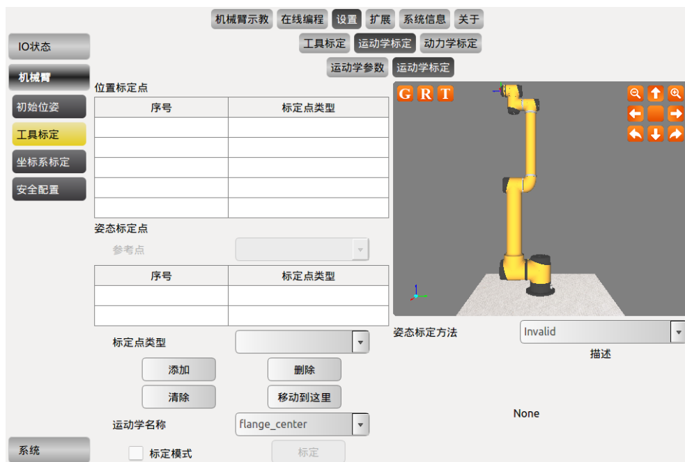
图 10-28 运动学工具标定
