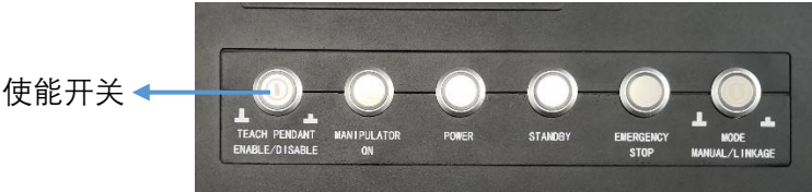
图 7-6 示教器使能开关位置
