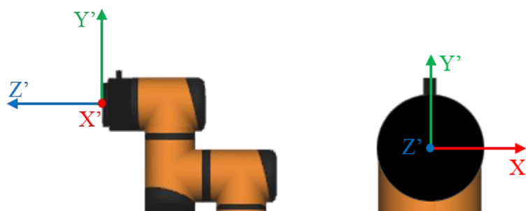
图 10-12 末端坐标系(flange_center)
