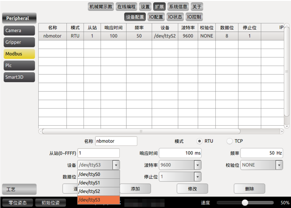
图 10-59 Modbus 设备配置
